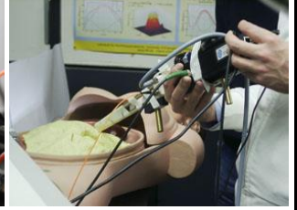
3D-Endoskopie mit ToF-Kamera und Laserillumination
