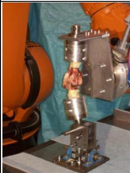
Prüfroboter mit Kraftsensor
